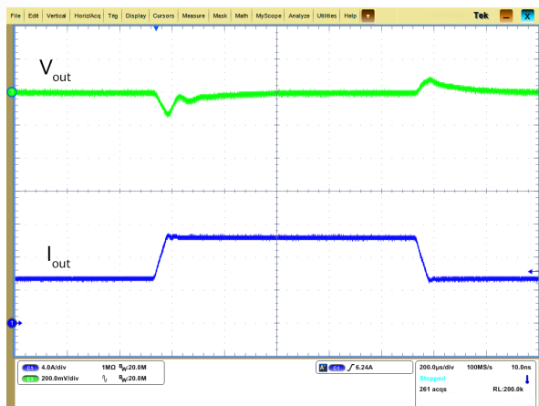
输出电压动态响应（负载：25%~50%~25%， V_{in}=48V , di/dt=0.1A/\mu s ）
